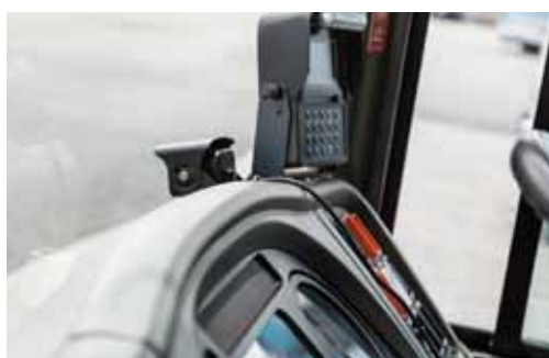
運転席の前、フロントガラスのすぐ後ろから、バス前方を捉えるカメラ
