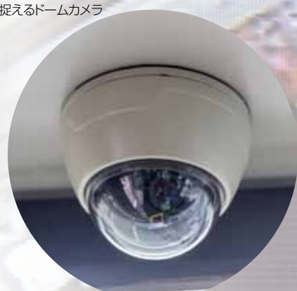
料金表示パネルの下に設置され、バス車内を捉えるドームカメラ
